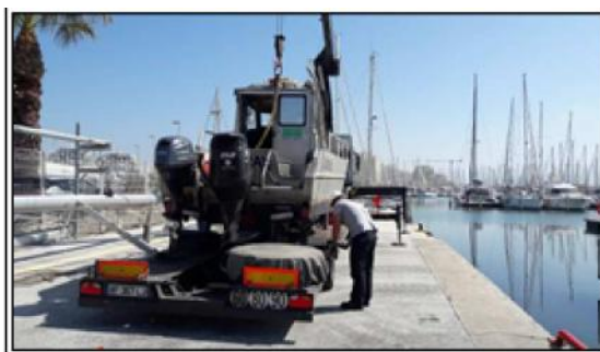
Mise à l'eau de la vedette par semi-remorque (grue hydraulique) depuis le quai du Port de la Grande Motte
