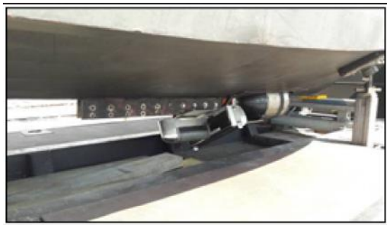
Sondeur multifaisceaux situé sous la vedette (à gauche) – Logistique embarquée (Droite)
