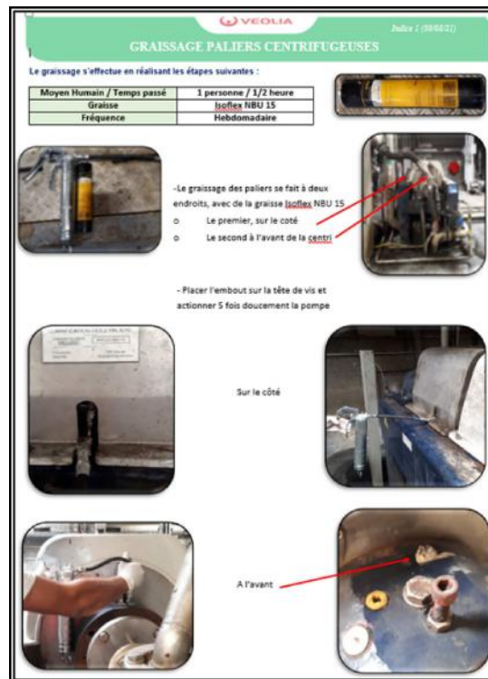
Mode opératoire simplifié de graissage des centrifugeuses
